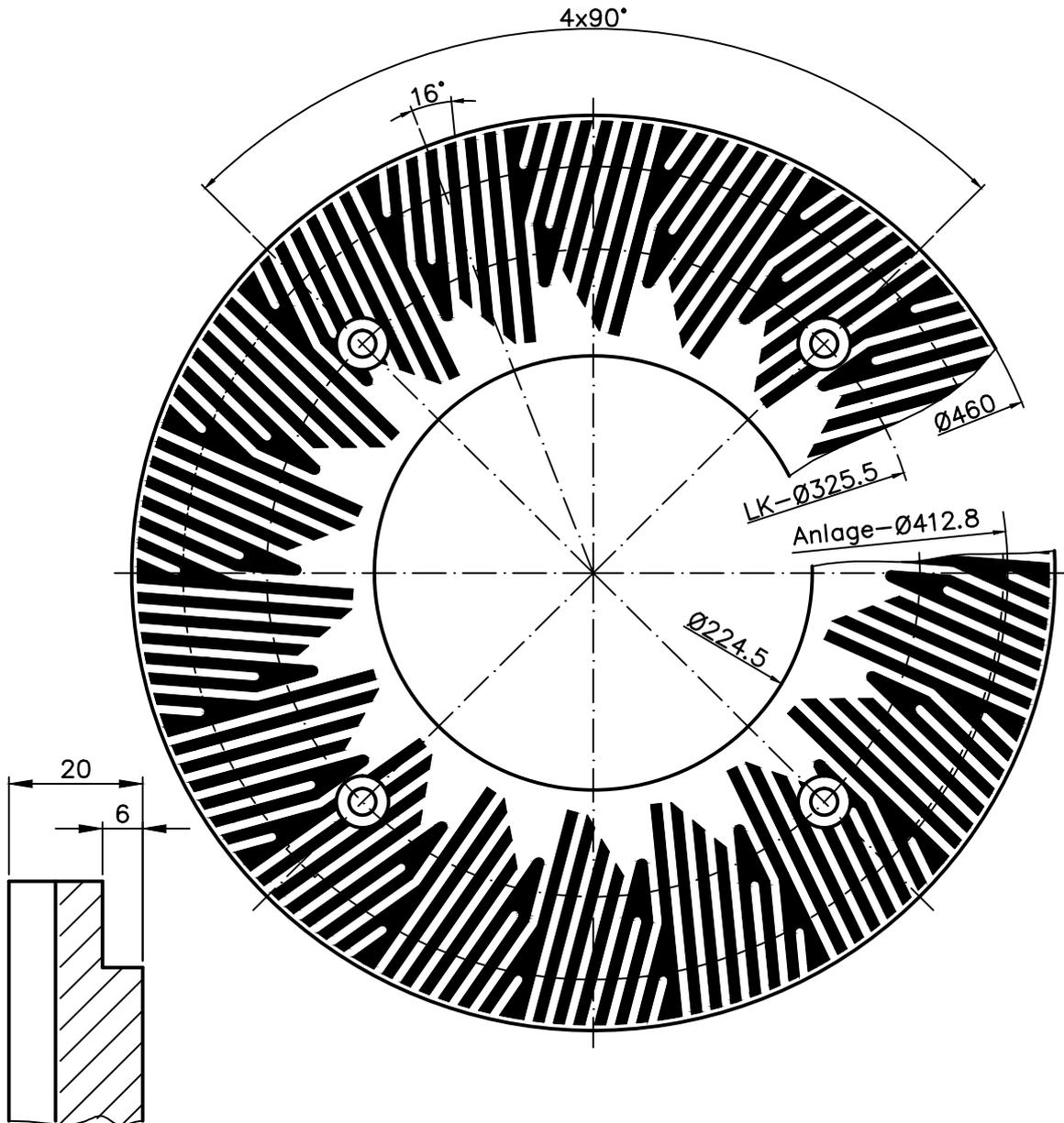
Rotor und Stator gleich
